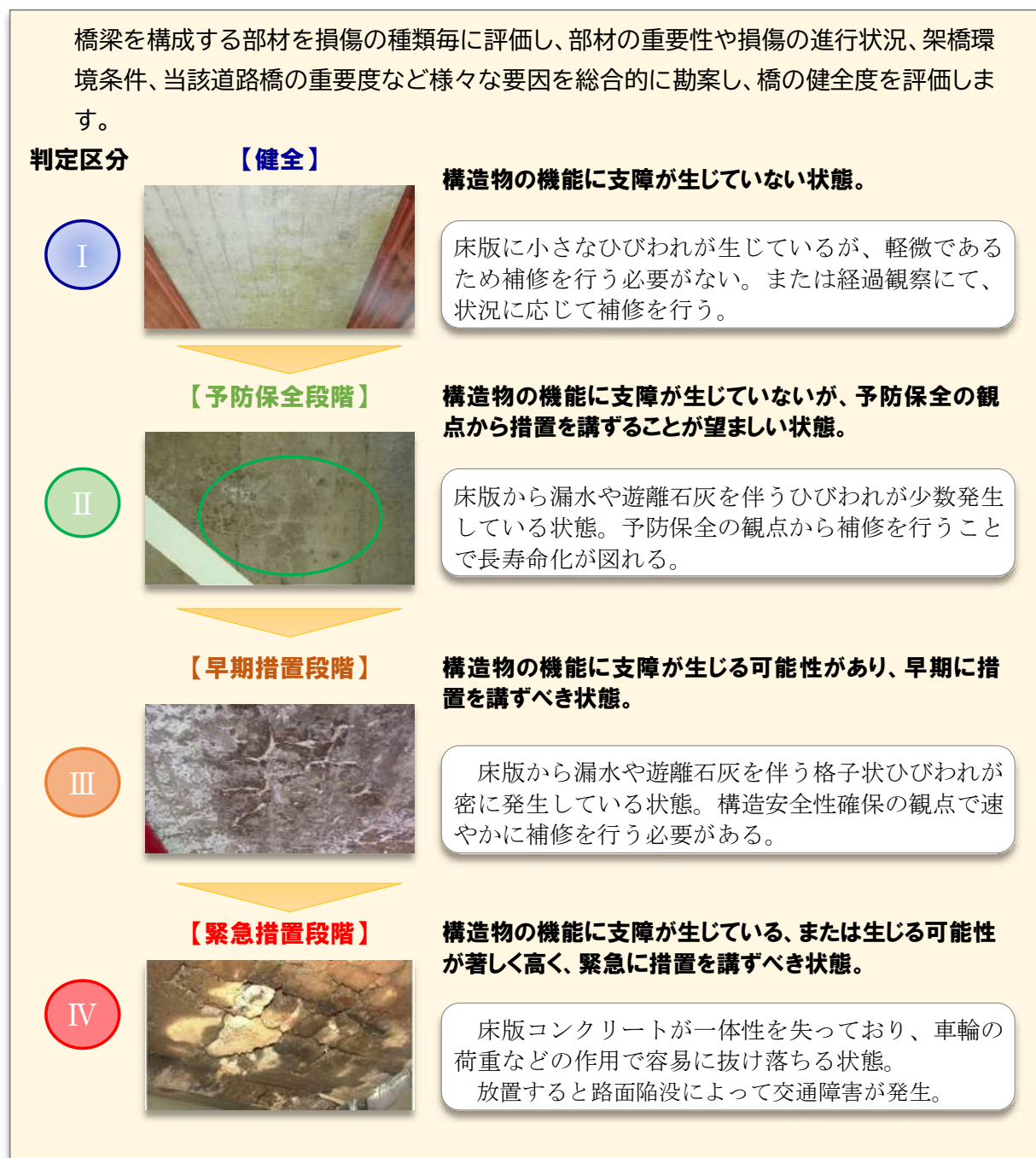
図 15 橋の健全度の事例 (判定Ⅱ～Ⅳ:道路橋定期点検要領 国土交通省 道路局)
