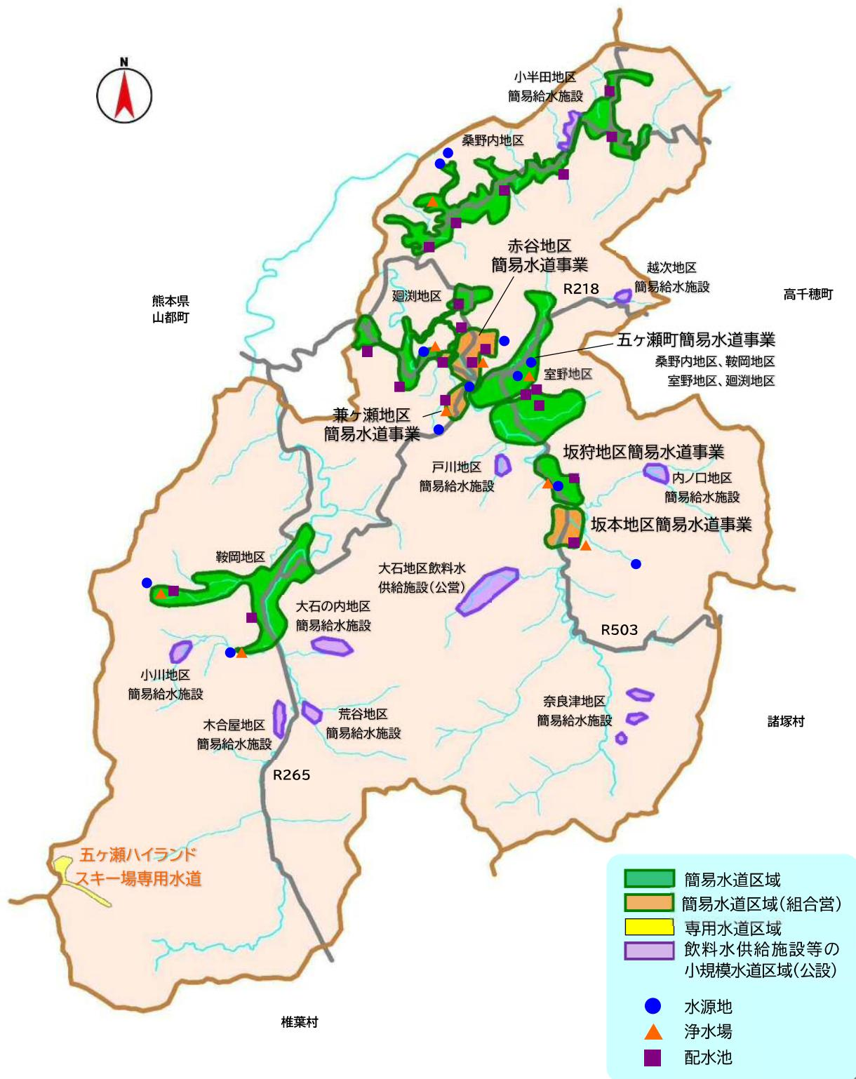
図 2-5 五ヶ瀬町の水道事業の給水区域と施設の概況
